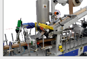
TUTKAL SÜRME MERDANELİ EVA / PO HOTMELT UYGULAMA İSTASYONU
