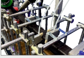
PRİMER UYGULAMA İSTASYONU PRIMER APPLICATION SYSTEM УЗЕЛ НАНЕСЕНИЯ ПРАЙМЕРА
