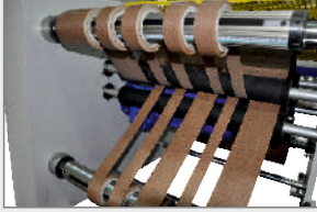
ALT-ÜST PNÖMATİK FOLYO SARGI ŞAFTLARI TOP-BOTTOM PNEUMATIC FOIL WINDING SHAFTS ВЕРХНИЙ И НИЖНИЙ ПНЕВМАТИЧЕСКИЕ НАМОТОЧНЫЕ ВАЛЫ
