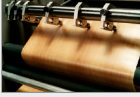
JİLET TİP BİÇAK İLE FOLYO DİLİMLEME SİSTEMİ SLITTING SYSTEM WITH RAZOR TYPE KNIFE СИСТЕМА НАРЕЗКИ ПЛЕНКИ ЛЕЗВИЯМИ
