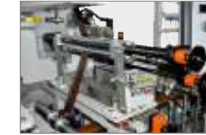
SLOT NOZUL İLE POLİÜRETAN HOTMELT (PUR) TUTKAL UYGULAMA SİSTEMİ POLYURETHANE HOTMELT (PUR) GLUE APPLICATION SYSTEM WITH SLOT NOZZLE ДЮЗА НАНЕСЕНИЯ ПУР КЛЕЯ (КЛЕЙ-РАСПЛАВ)
