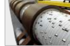
FRİKSİYON ŞAFTLI SARGI SİSTEMİ REWINDING SYSTEM WITH FRICTIONAL SHAFTS СИСТЕМА НАМОТКИ С ФРИКЦИОННЫМИ ВАЛАМИ
