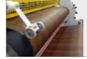
MEKANİK METRAJ SAYACI MECHANICAL COUNTER МЕХАНИЧЕСКИЙ ИЗМЕРИТЕЛЬ ДЛИНЫ ПЛЕНКИ
