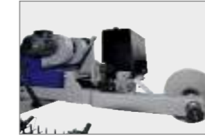
ÇİFT KOMPONENTLİ SOLVENT (PU) TUTKAL UYGULAMA SİSTEMİ DOUBLE COMPONENT SOLVENT (PU) GLUE APPLICATION SYSTEM СИСТЕМА НАНЕСЕНИЯ ДВУХ- КОМПОНЕНТНОГО КЛЕЯ НА ОСНОВЕ РАСТВОРИТЕЛЯ
