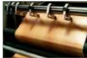
JİLET TİP BİÇAK İLE FOLYO DİLİMLEME SİSTEMİ SLITTING SYSTEM WITH RAZOR TYPE KNIFE СИСТЕМА НАРЕЗКИ ПЛЕНКИ ЛЕЗВИЯМИ
